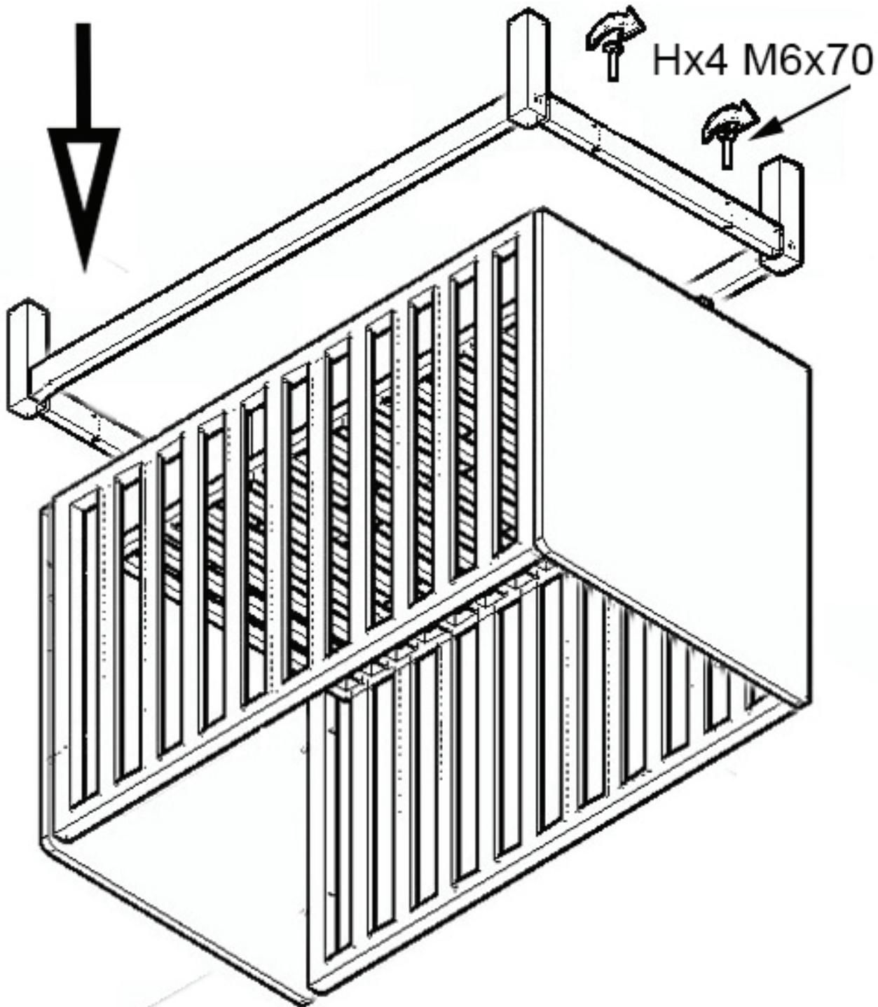
**Etape 3 : Utilisez les pièces des étapes 1 et 2 et quatre boulons de raccord H**
