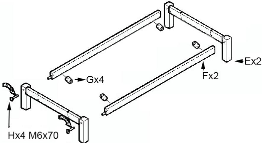
**Etape 1 :** Utilisez les deux traverses **F**, les deux piétements **E**, quatre excentriques **G** et quatre boulons de raccord **H**
