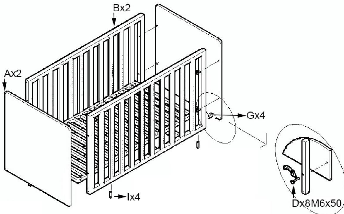
**Schritt 2 :** Benutzen Sie beide Kopfenden **A**, beide Seiten **B**, acht Bolzen **D**, vier Exzentern **G** und vier Holzdübeln **I**
