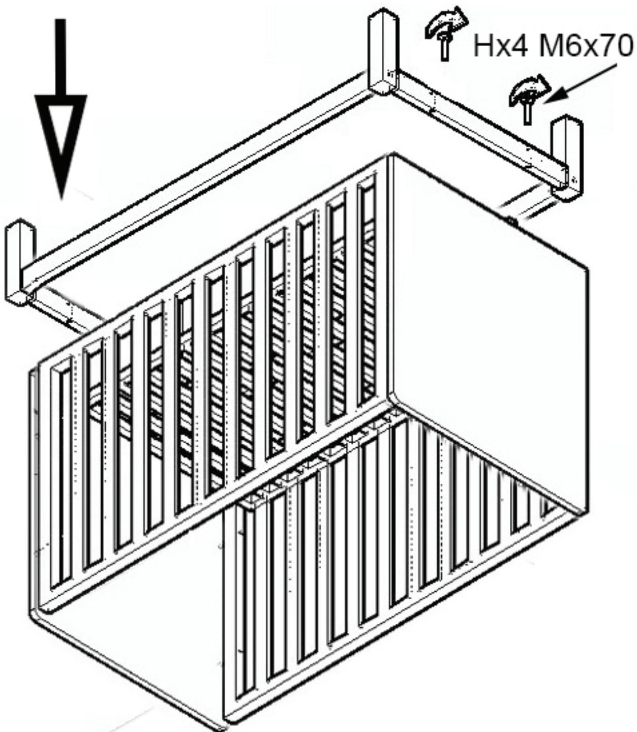
**Schritt 3 :** Benutzen Sie die Bauteile von Schritt 1 und 2 und vier Verbindungsbolzen H
