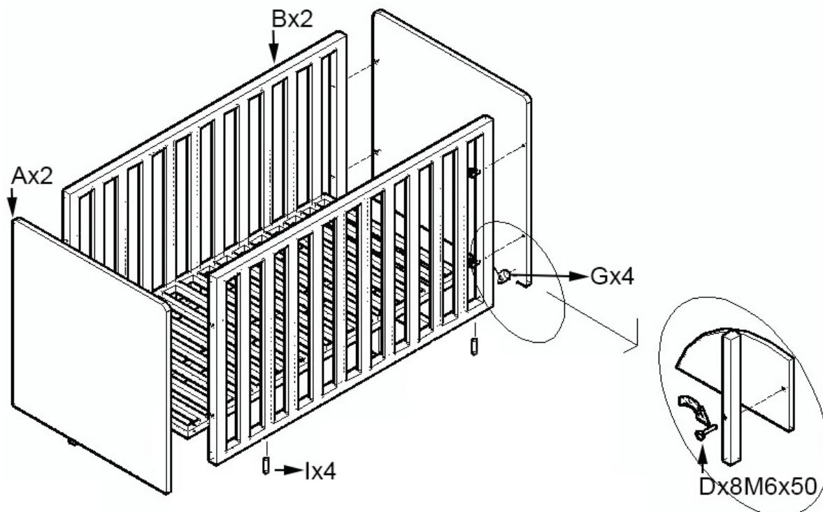
**Etape 2 :** Utiliser les deux panneaux terminaux **A**, les deux côtés **B**, huit boulons **D**, quatre excentriques **G** et quatre chevilles en bois **I**
