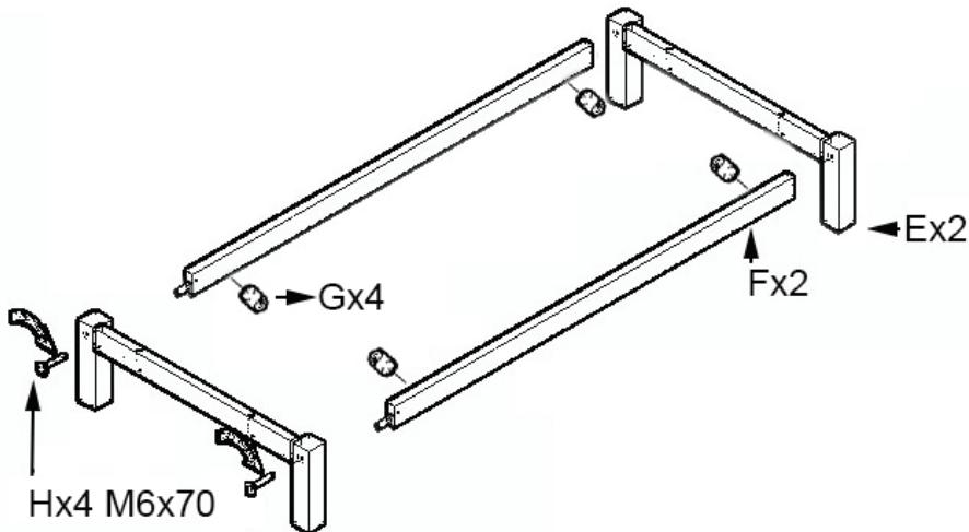
**Schritt 1 :** Benutzen Sie beide Traversen **F**, beide Füße **E**, vier Exzenter **G** und vier Verbindungsbolzen **H**
